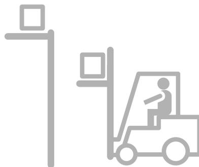
Il pallet deve entrare nel vano alzato di circa 50 mm rispetto al piano del pavimento. Non strisciare i pallet sul pavimento.
